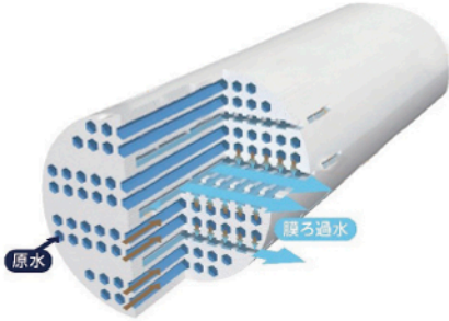
▲0.0001mmの穴に水を通し、ろ過するため小さな汚れも取り除くことが可能
